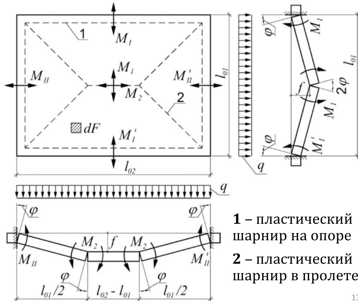
**1** – пластический шарнир на опоре
