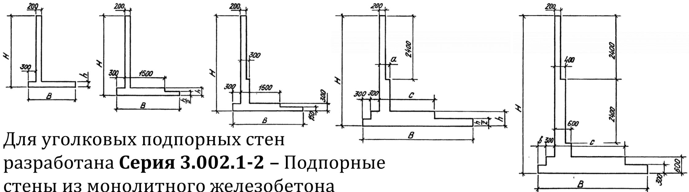
Для уголковых подпорных стен разработана **Серия 3.002.1-2** – Подпорные стены из монолитного железобетона
