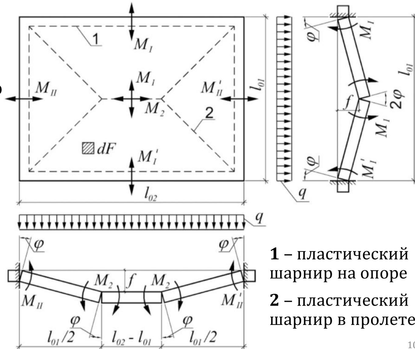
**1** – пластический шарнир на опоре
