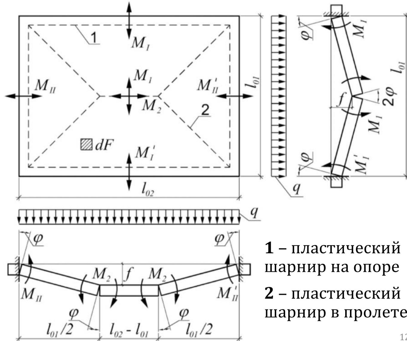
**1** – пластический шарнир на опоре
