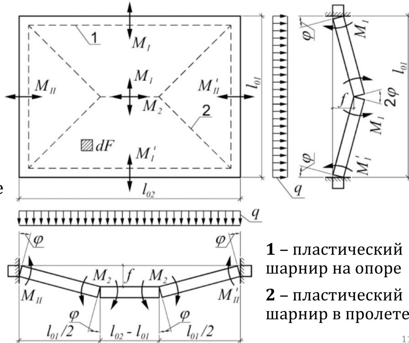
1 – пластический шарнир на опоре
